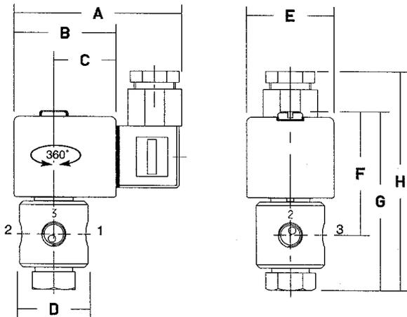
**3/2-Wege-Magnetventil, stromlos geschlossen, 230 V, 50 - 60 Hz, direktgesteuert**
